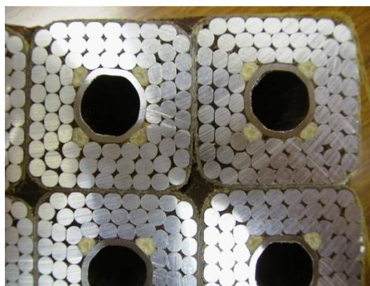
Fig. 10 アルミストランド線の断面図
