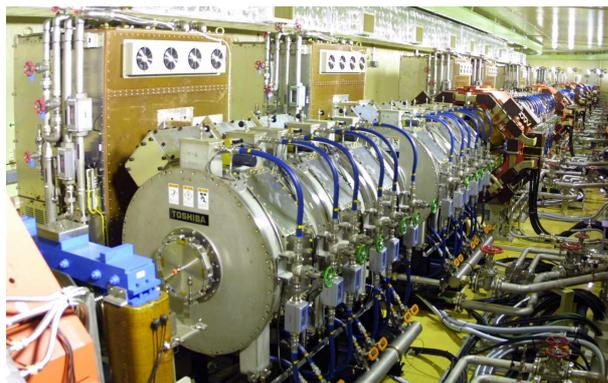
Fig. 11 RCS の加速空洞
